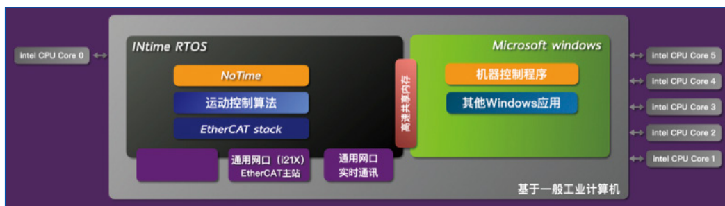
图：ProU NoTime 控制器将运动控制程序和机器视觉等软件整合在同一硬件中
