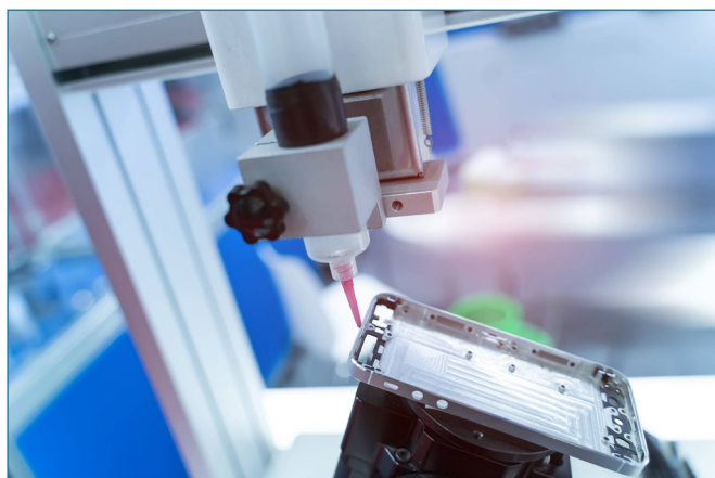
图 14. 手机制造中的点胶工艺
